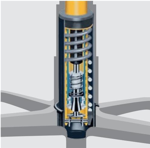
**Mecánica Sedo Lift.** Incluso en la posición más baja, este sistema de ajuste de altura de asiento patentado a nivel mundial garantiza una suave amortiguación al sentarse, cuidando la espalda. En el tubo guía se han fresado unas muescas laterales en las que encastra el mecanismo. Se descarga así el amortiguador de gas aumentando considerablemente su vida útil. Según las condiciones de 30 años de garantía de Sedus.
