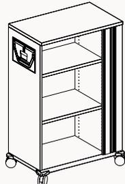
Altura 1148 mm (3 AA), anchura 720 mm, profundidad 436 mm
