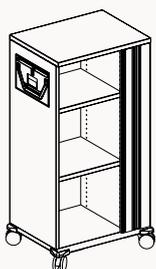
Altura 1148 mm (3 AA), anchura 550 mm, profundidad 436 mm
