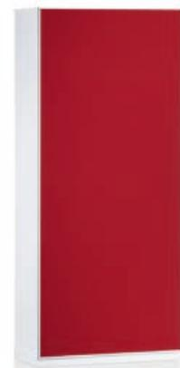
**Pannello posteriore in tessuto.** Tutti gli armadi possono essere dotati di un pannello posteriore in tessuto fonoassorbente. Il telaio in alluminio racchiude la schiuma assorbitrice spessa 18 mm insieme a un'asse in truciolo forato e rivestito in tessuto.
