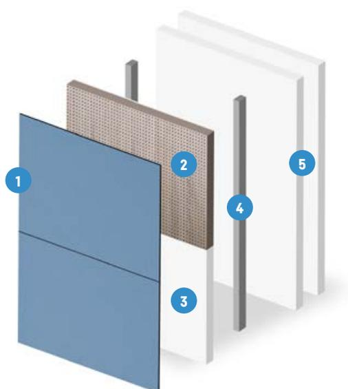
La struttura a parete in più parti con materiale integrato ad alta fonoassorbenza e la porta in vetro con guarnizione automatica di qualità e chiusura magnetica opzionale contribuiscono a un isolamento acustico ottimale del se:cube.
