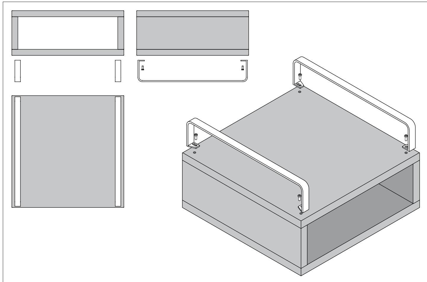
**Beistelltisch – Montageanleitung:** Kubus umgekehrt auf den Boden legen; darauf achten, dass die Tischplatte beim Bodenkontakt nicht verkratzt wird. Vier Schrauben (M8) am Kufengestell einsetzen, mit dem Innensechskantschlüssel im Uhrzeigersinn an der Bodenplatte eindrehen und festziehen. Ausrichtung des Kufengestells am Kubus beachten. Angeschrägte Kufen-Flächen zeigen nach außen.
