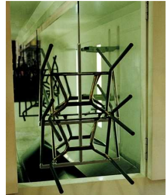
Abbildung 9: Pulverbeschichten von Stuhlgestellen
